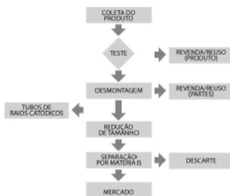
Figura 1: Sistema de reciclagem de um eletroeletrônico
